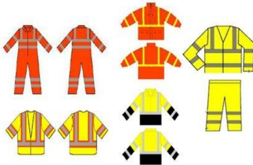
Diseño de distribución de cinta reflectiva y costura para prendas de Clase 3 (Personal expuesto a la vía pública)
