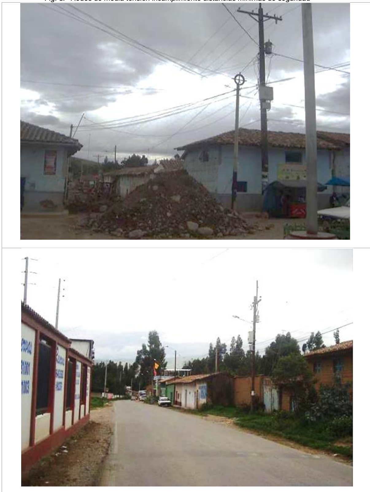
Fig. 3. Redes de media tensión incumplimiento distancias mínimas de seguridad
