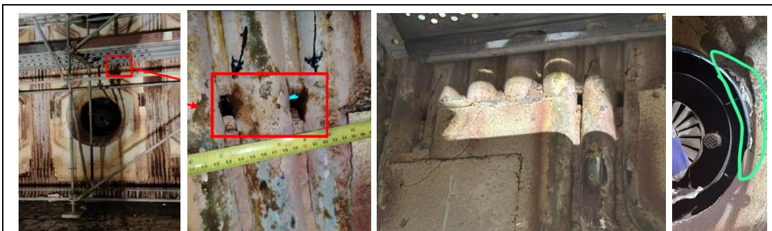
Agujeros pasantes con vistas al exterior ubicado en la parte superior de quemador E
