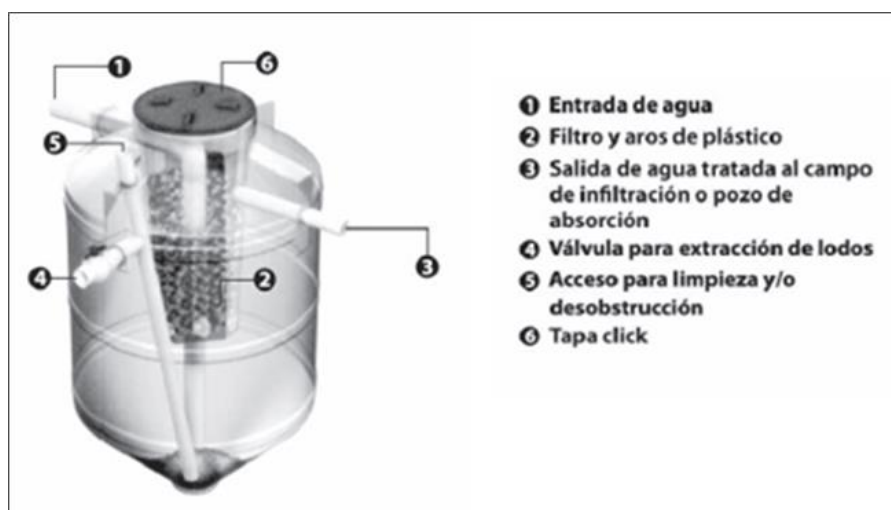
Figura N° 2. Componentes del biodigestor
