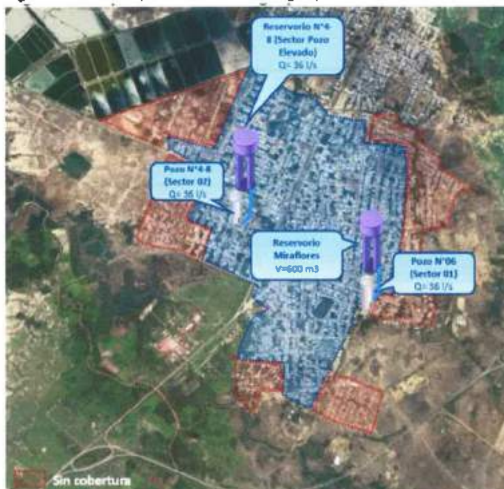
Imagen N° 3.5.9-1. Esquema del sistema de agua potable de la localidad de Zarumilla
